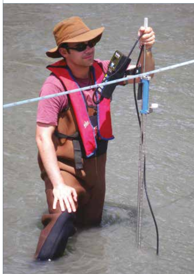
« JAUGEAGE AVEC UN COURANTOMÈTRE ACOUSTIQUE SUR L'ARC EN MAURIENNE (73) » (IRSTEA)
