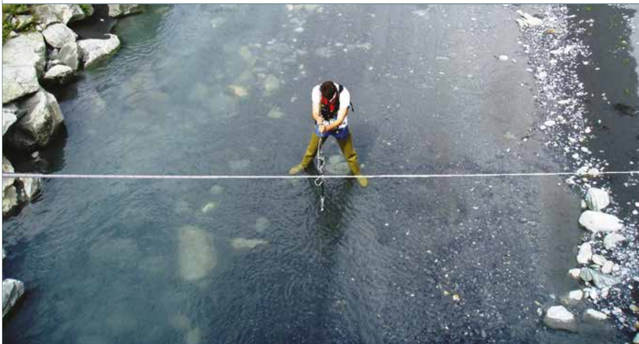
FIGURE 4.4 : JAUGEAGE À LA PERCHE – POINT PAR POINT (EDF-DTG)
